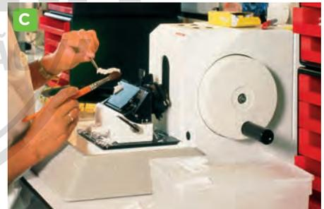
O micrótomo é o aparelho utilizado para cortar em fatias finíssimas o material a ser observado ao microscópio.
