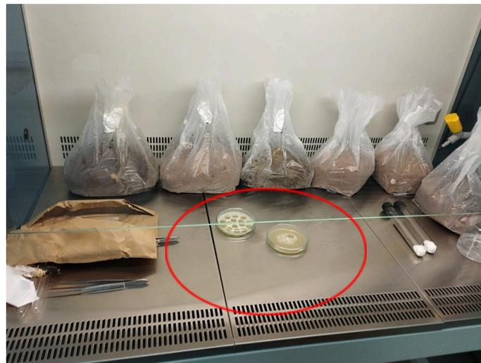
Figura 26. Placas de petri com discos recortados por tubos de ensaio, e sacas de substrato inoculadas dentro da CFL.
