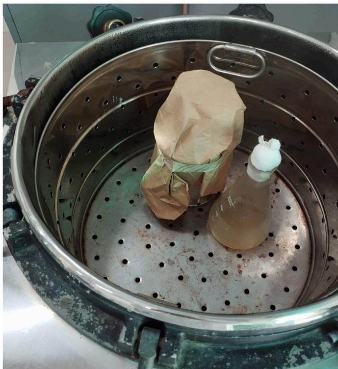
Figura 21. tubos de ensaio com ágar e o restante do ágar no Erlenmeyer dentro da autoclave.
