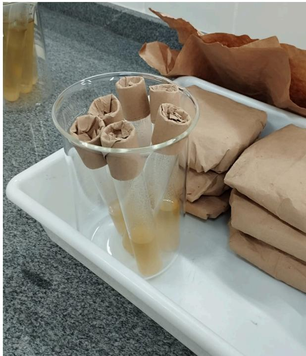
Figura 20. Recipientes fechados prontos para a autoclavagem.
