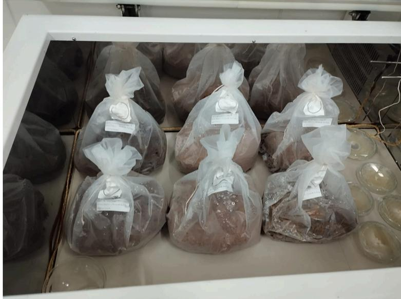
Figura 27. Substratos inoculados dispostos dentro de uma estufa.
