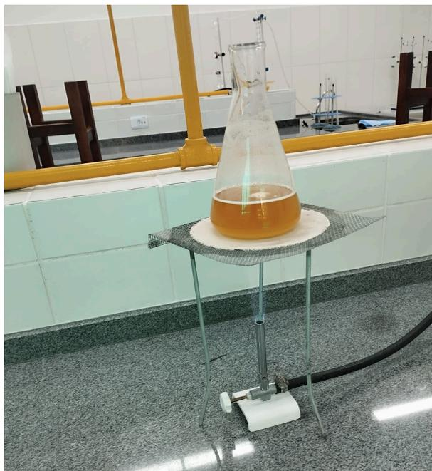
Figura 19. Erlenmeyer sendo aquecido no bico de bunsen acima de uma placa de amianto.
