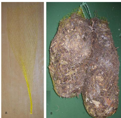
**Figura 3.** Saco utilizado para conter as amostras durante a extração (A); Amostras dispostas no saco para extração (B). Fotografias: ©Victor de C. Calvanese, 2014.
