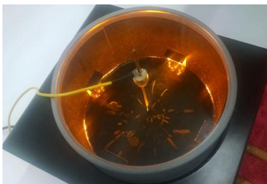
Figura 5: câmara de nuvens por difusão, fabricado pela PASCO SCIENTIFIC.
