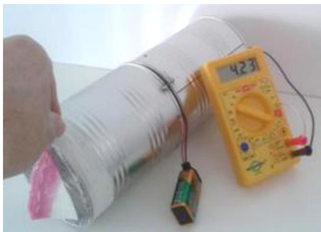
Figura 4: Câmara pronta com fonte radioativa (camisinha de lampião) e medida da radiação no multímetro.
