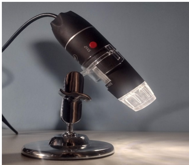
Fig. 7. Microscópio digital da Knup, modelo KP-8012, com aumento de 20 a 40 vezes (Fonte: do autor, 2022).
