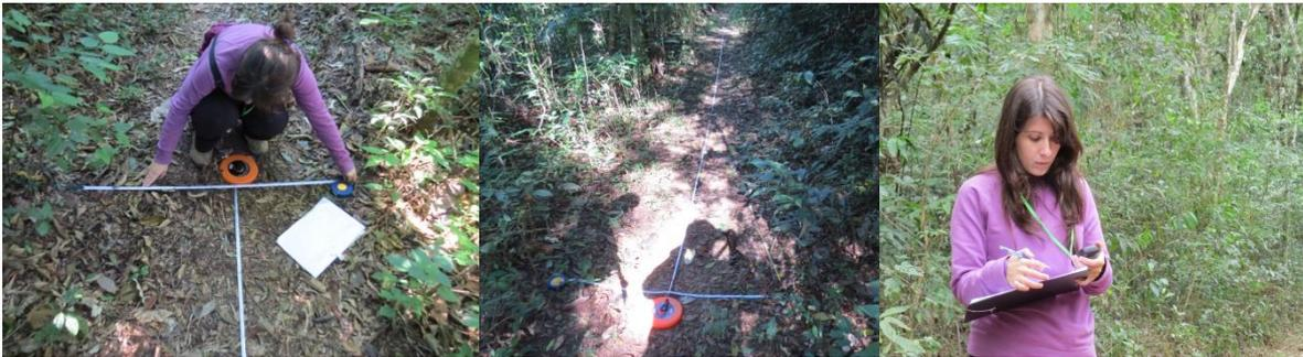
Figura 29 – Marcando a largura, comprimento a cada 100 m e anotando os dados e as coordenadas geográficas na ficha de campo.
